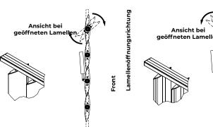
Man kann zwischen der Lamellendrehrichtung im Uhrzeigersinn oder gegen den Uhrezeigersinn wählen.
